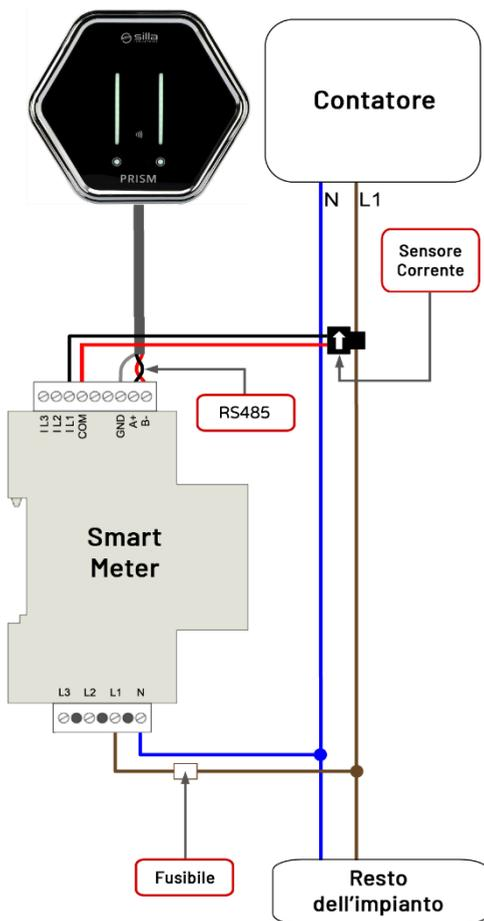
Per l'installazione del dispositivo Smart Meter, riferirsi al relativo manuale in dotazione. Utilizzare fusibili di tipo **gL (IEC 269)** o tipo **M da 0.5A a 2A** per la protezione dello strumento.
